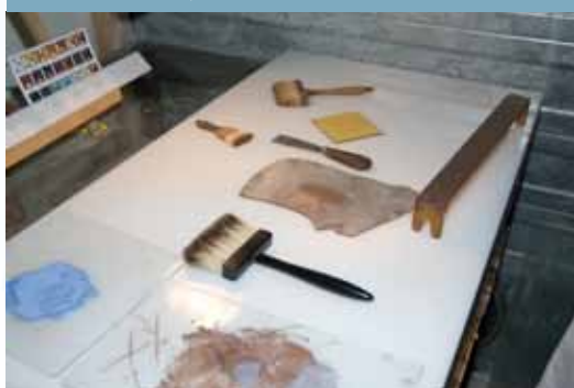
Matériel de restauration de la peinture d'un vitrail : table lumineuse (le travail de restauration de la peinture se faisant toujours par transparence) et pinceaux pour travailler la grisaille. © ADL, L.Voland
