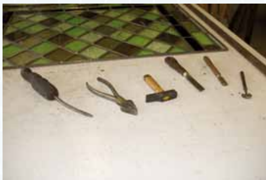
Les principaux outils du maître-verrier : fer à souder, pince à gruger, couteau à plomb, marteau de montage, roulette et diamant (de gauche à droite). © ADL, L.Voland
