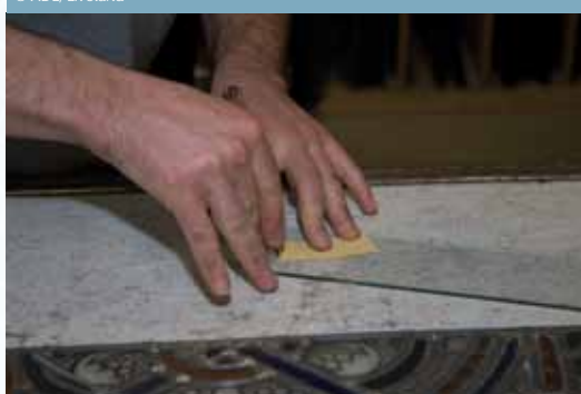
À l'aide de la roulette, le maître-verrier procède à la découpe des pièces de verre en suivant son calibre. © ADL, L.Voland
