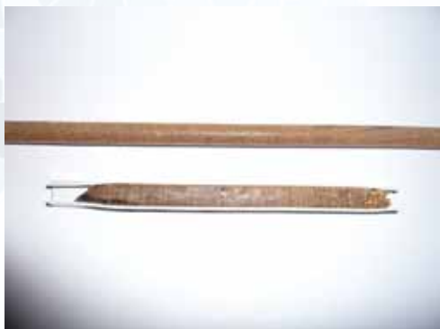
Vue d'une carotte brute après prélèvement (en haut) et vue d'une carotte dans une gaine plastique (en bas) et aplanie au cutter avec à droite l'aubier présentant des trous réalisés par des larves d'insectes. © C.Perrault
