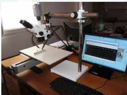
Système permettant de mesurer la largeur des cernes. La carotte est disposée sur un chariot qui défile sous une loupe binoculaire. Le déplacement du chariot (du début à la fin du cerne) est donné par un logiciel qui le convertit en centièmes de millimètres. © C.Perrault
