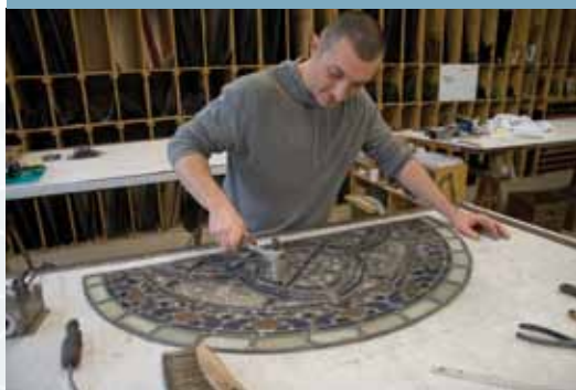
Après le sertissage, ce vitrailiste procède à la soudure du réseau des plombs avec de l'étain. © ADL, L.Voland
