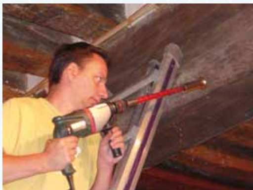
Christophe Perrault effectuant un prélèvement par carottage dans une poutre du plafond de l'ancien château de Châteauneuf-sur-Loire. © C.Perrault
