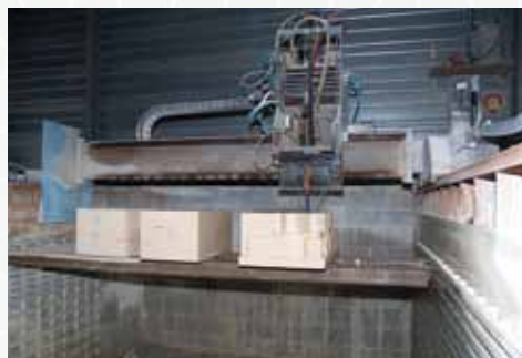
Fraiseuse réalisant l'épannelage de pierres dont la taille sera achevée à la main. © ADL, L'Volland
