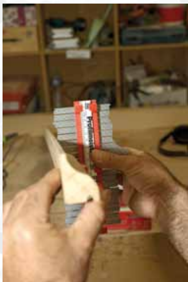
Le menuisier utilise un peigne pour obtenir l'empreinte de la moulure. À partir de ce relevé, il réalise un fer qui, mis sur une toupie, permettra la réalisation à l'identique de la moulure. © ADL, F. Meunier
