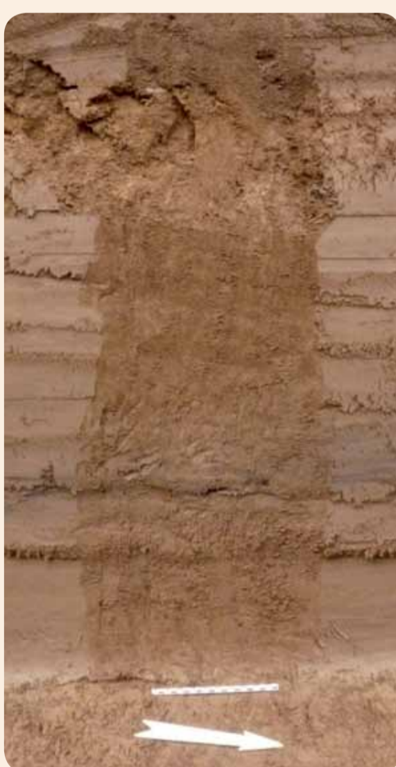
Log géomorphologique : il permet d'étudier l'organisation et les modes de dépôt des sédiments • Marcilly/Sandillon, déviation RD 921
