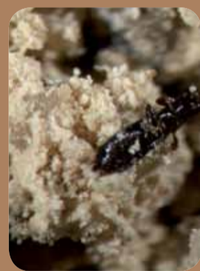
Observation au microscope (grossissement x3), avec un insecte piégé, indice de la saison de réalisation de la maçonnerie • La Neuville-sur-Essonne, 153 Grande Rue
