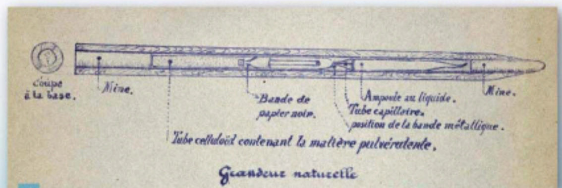
6 Schéma d'un crayon explosif, juillet 1918.
